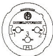
Figuur 3 Metingen altijd tussen de 'hot' en 'cold' van het signaal
