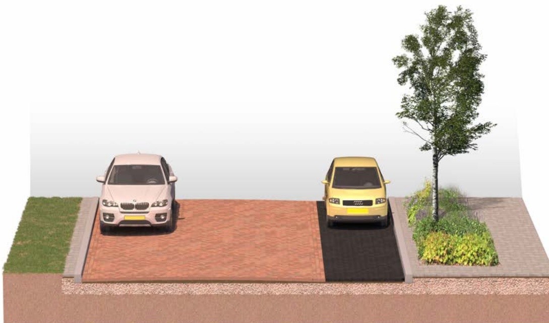
Afb. 1.13 - Principeprofiel bij de aangesloten bebouwing: aan één zijde worden formele langspaarkeerplaatsen aangelegd, aan de andere zijde wordt op de rijbaan (5,5m) geparkeerd.
