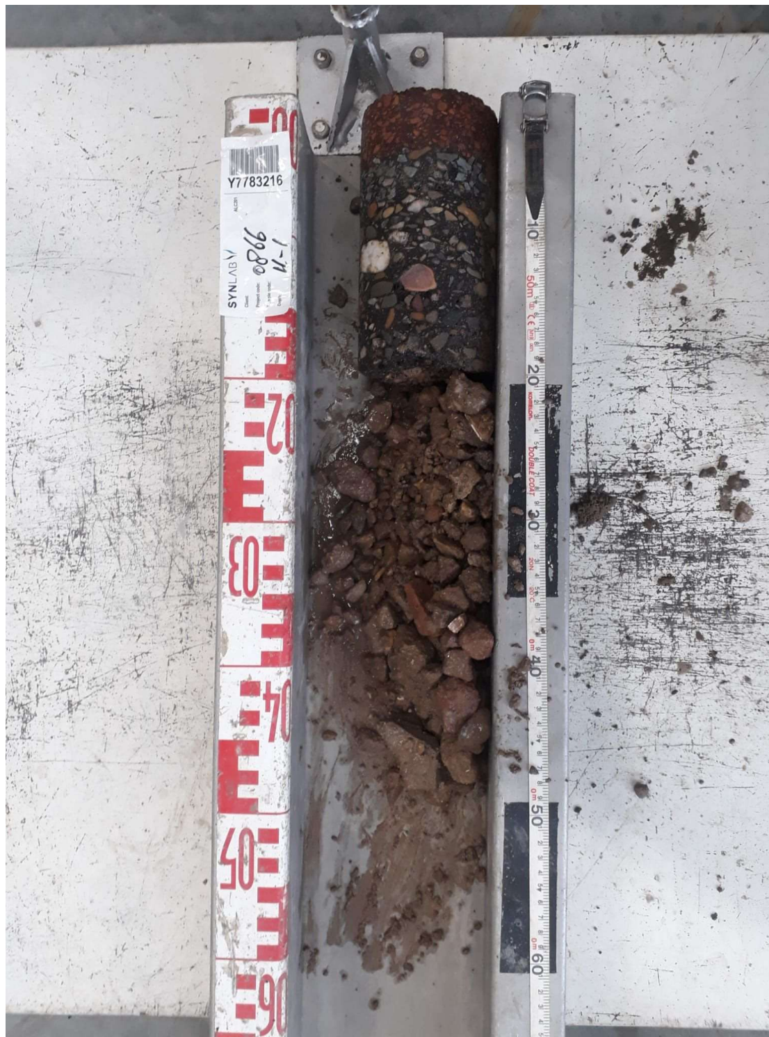
IDKR20220866 - Asfaltkolom boring 011
