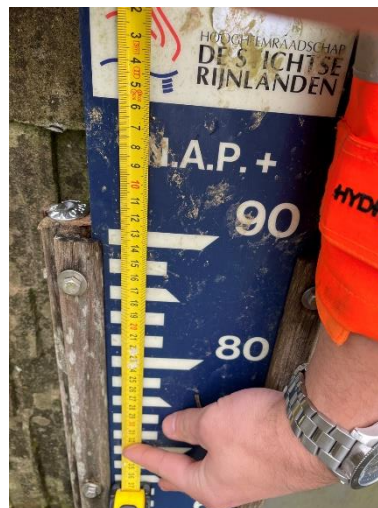
Figuur 9-7: Meetspijker verkeerd geplaatst.
