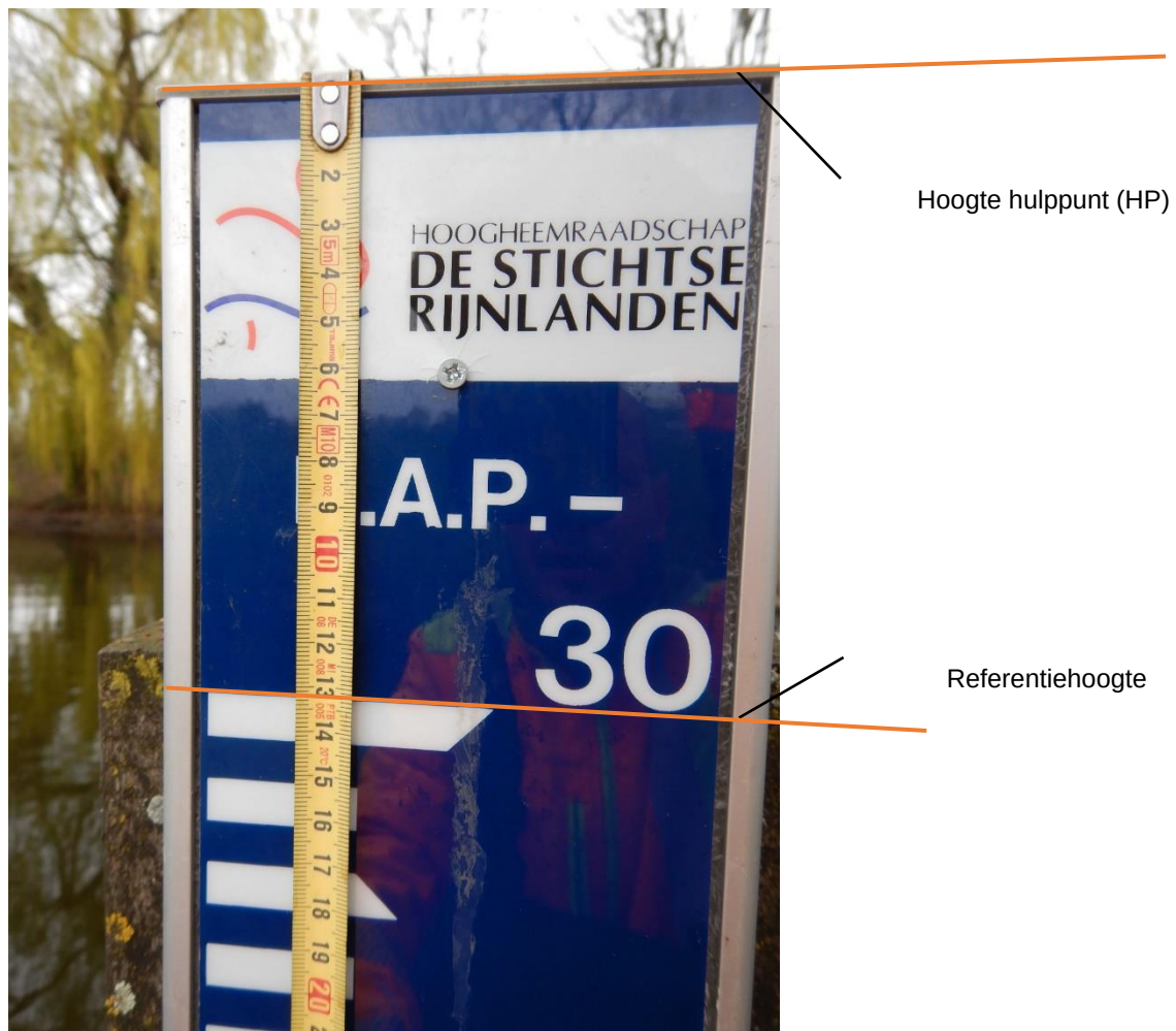
Figuur 9-8: Peilschaal met referentiehoogte en hoogte hulppunt
