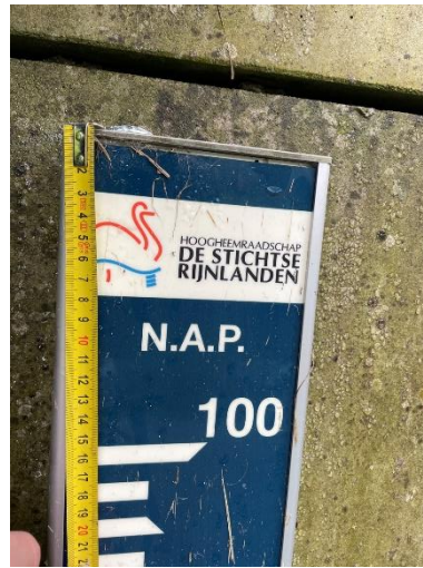
Figuur 9-10: Aflezing rolmaat niet juist - niet loodrecht op aflezing en scheef - daarnaast meetspijker in kop peilschaal die versteld kan worden - ook niet geschikt als hulppunt.
