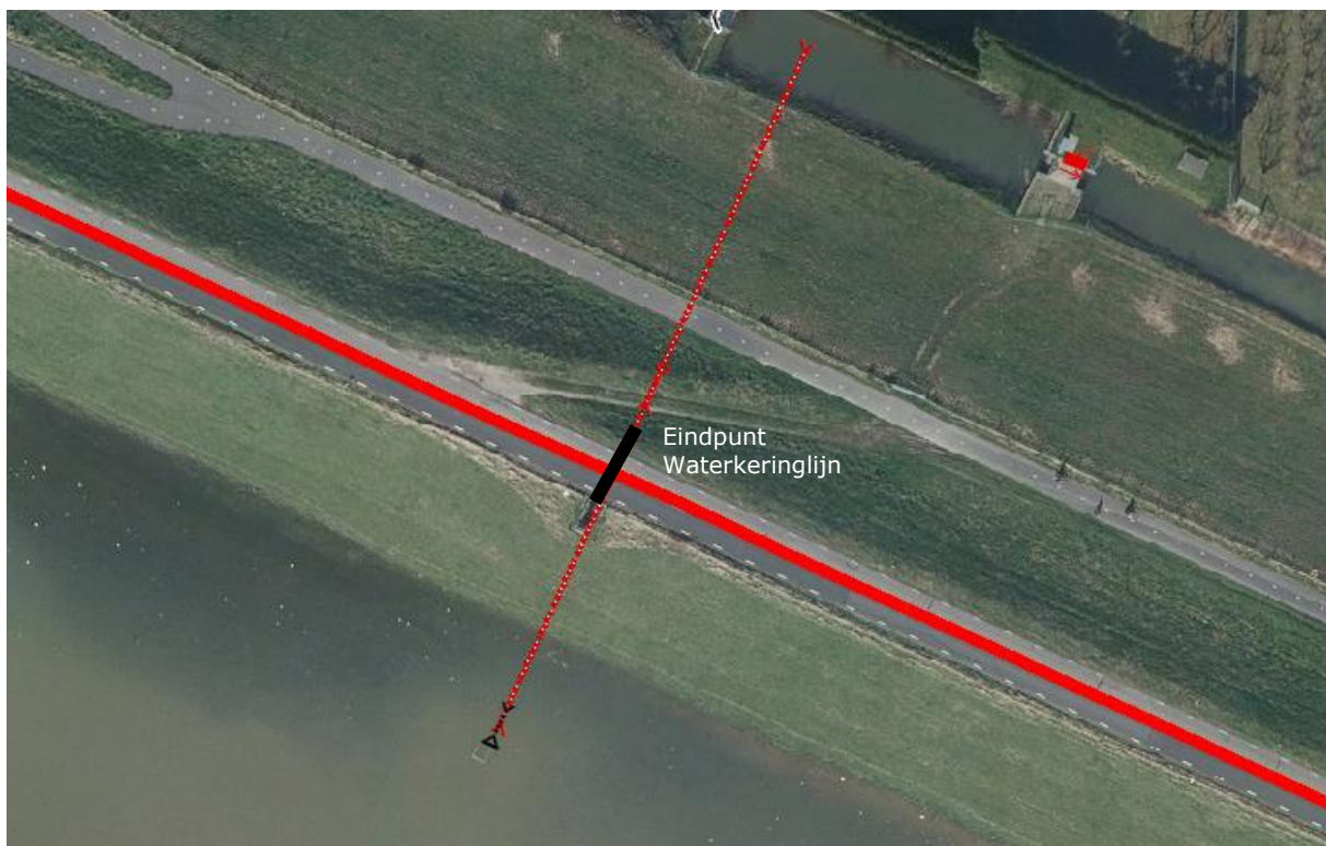
Figuur 8-40: Opknipping van waterkeringlijn bij een koker kunstwerk (duiker/inlaat). Er komt dus geen subtype Kunstwerk
