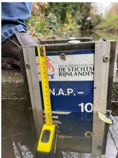
Figuur 9-6: Meetspijker op kop plank peilschaal i.p.v. beton.
