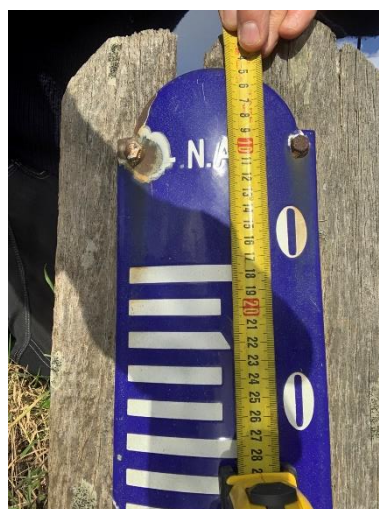
Figuur 9-14: Hoogte hulppunt niet goed gekozen en niet zichtbaar.
