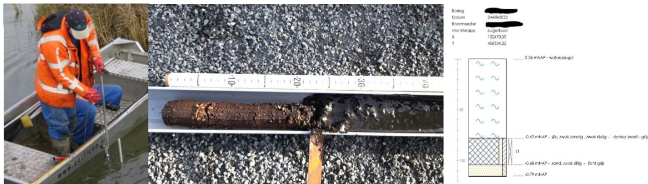
Figuur 2.8: Verificatiemeting onderzijde sedimentlaag / overgang naar vaste bodem.
