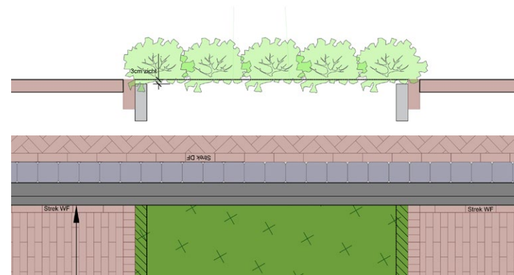
Detail plantvak in het trottoir
