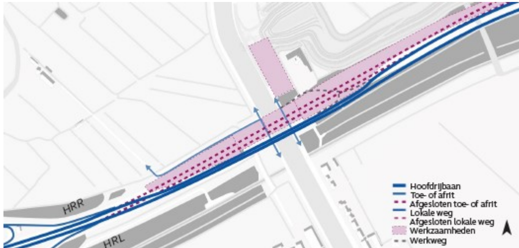
Figuur 5: Schets hoofdfasering Weginfrasysteem Kaagbrug
