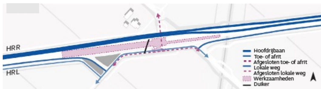
Figuur 3: Schets hoofdfasering Weginfrasysteem Lisserweg
