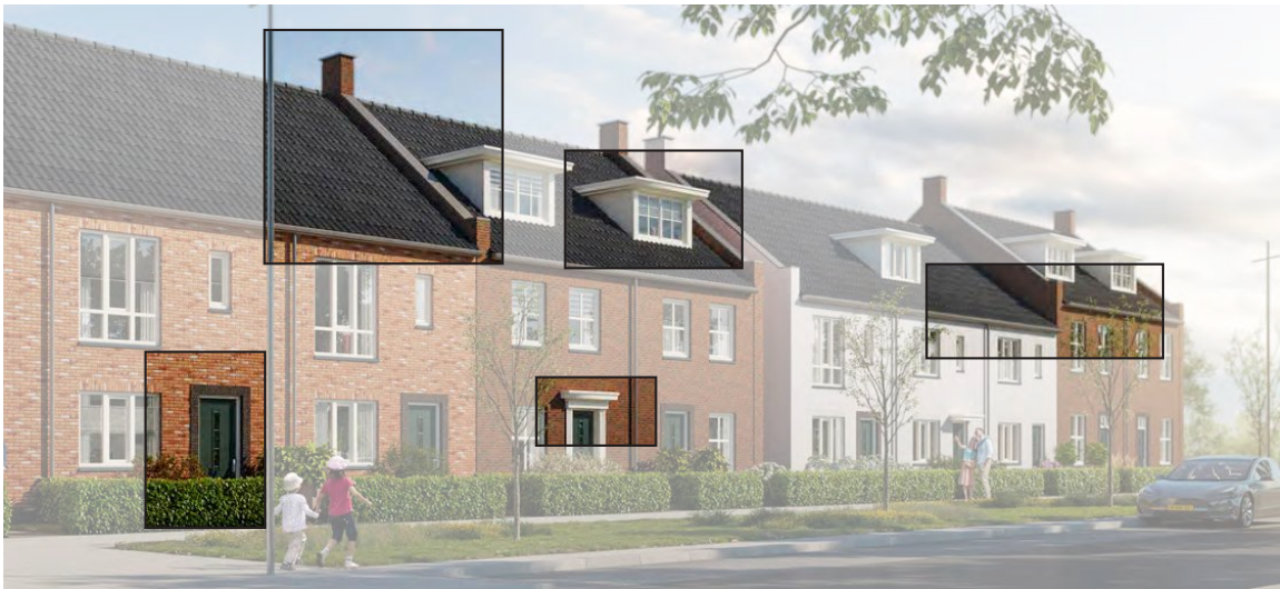
ritmiek + samenhang van bebouwing versterkt door: baksteenkleur, doorgestoken draagmuur, variatie in goothoogte etc.
