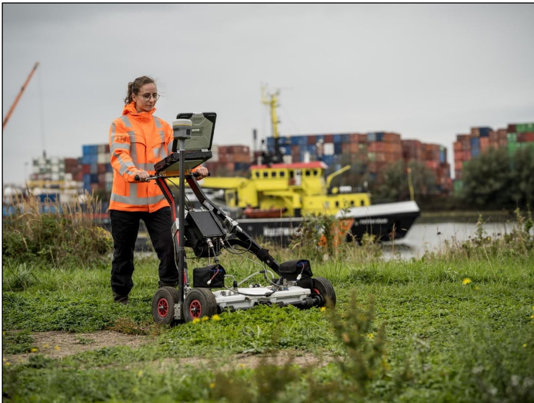
Figuur 5: IDS Hi-Mod 200/600 Mhz grondradar.
