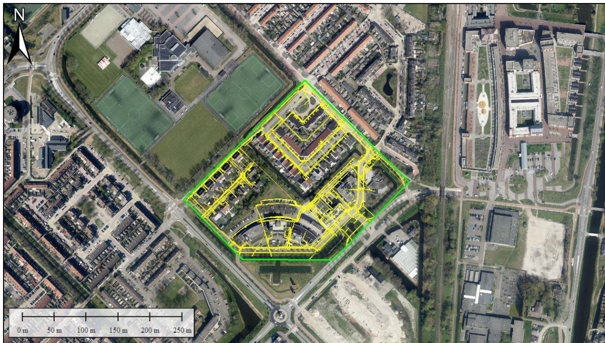
Figuur 9. Minimale bodemroering (geel) veroorzaakt door de aanleg van kabels en leidingen binnen het projectgebied. Bron: Kadaster.
