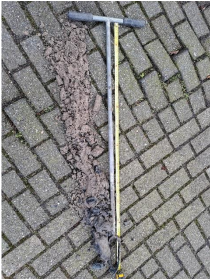
Foto: beeld van boring 2, bovenin met name zand, onderin klei
