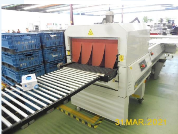
Gebruik van krimptunnels.
