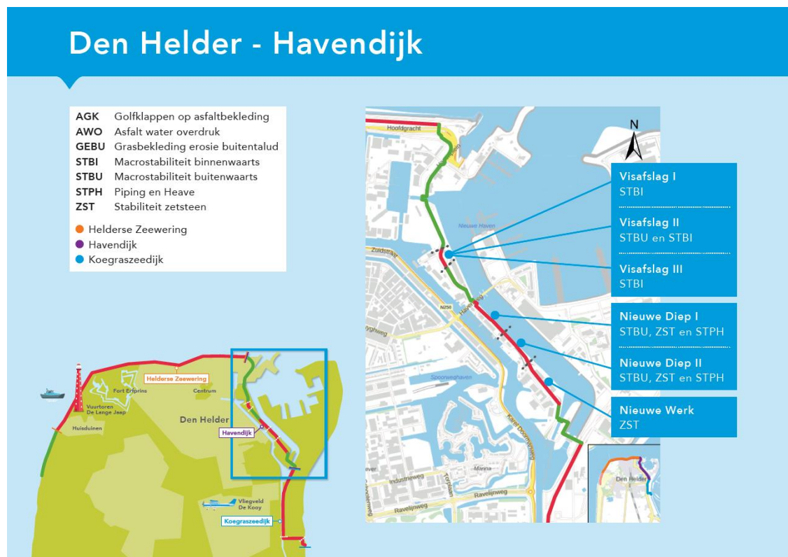
Figuur 1-2: Ligging Havendijk met de afgekeurde delen in rood aangegeven.
