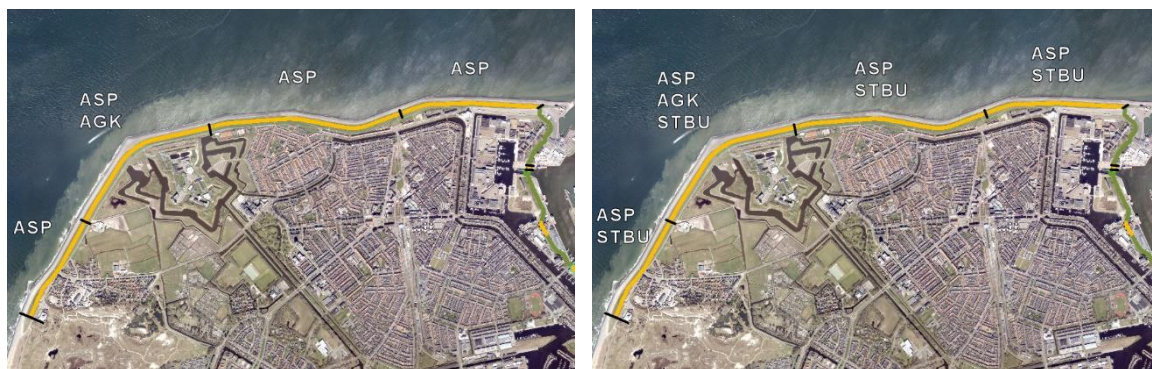
Figuur 7: Waterveiligheidsoordeel samengevat voor alle faalmechanismen voor de Helderse Zeewering tot 2023 (rechts) en tot 2073 (links). Groen is voldoende en oranje is onvoldoende.
