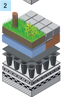
Opbouw Nophadrain Extensief (1) en Intensief (2) Groendaksysteem
