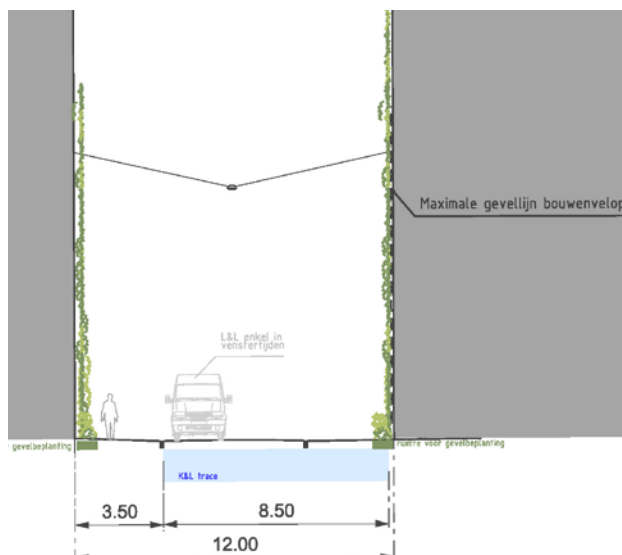
Afbeelding 23: B-C Doorsnede openbare ruimte Van der Kunstraat
