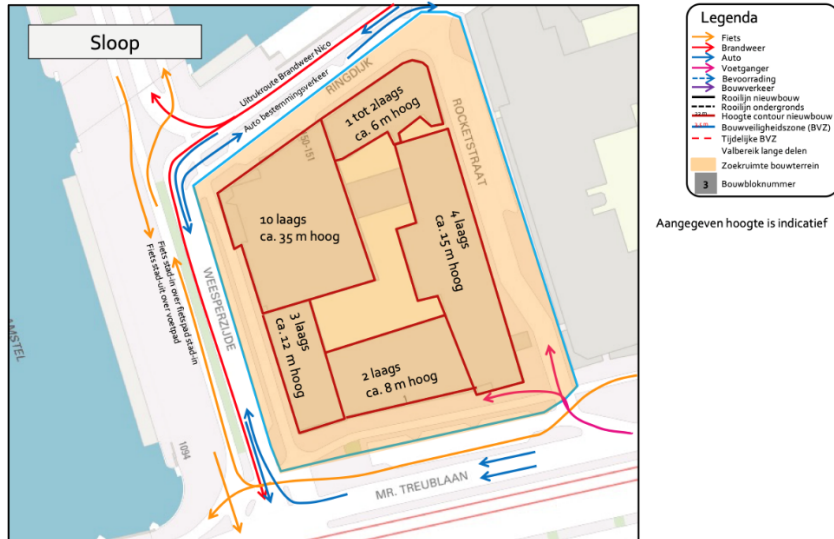
Figuur 5.2.3. Bouwstep Sloop bestaand pand i.c.m. met minimaal benodigde bouwveiligheidszone
