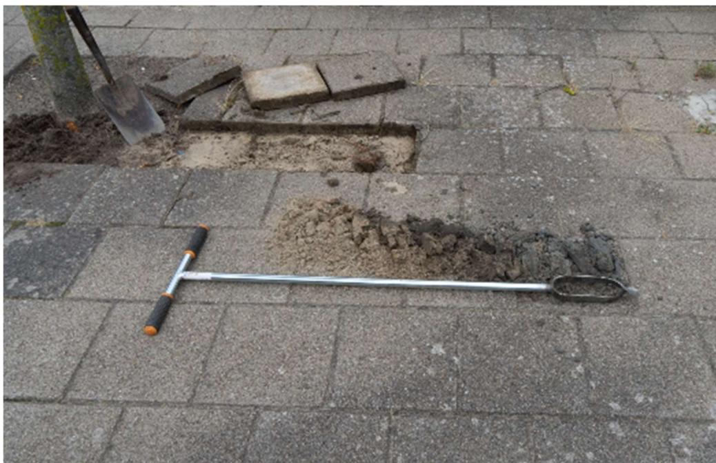
Afbeelding 21: boring rondom de groeiruimte van de boom. Geen bruikbare grond of substraat voor de bomen
