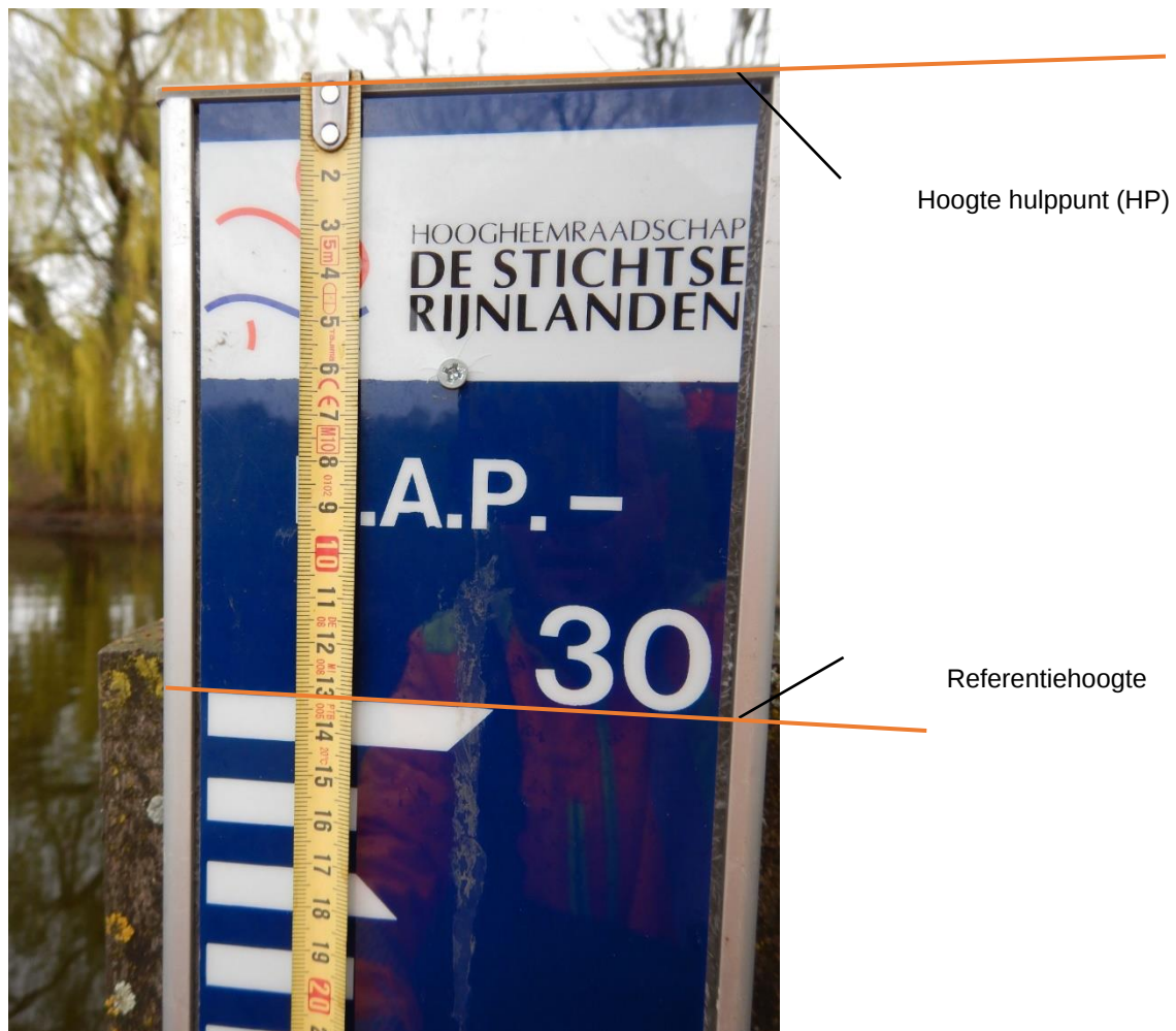
Figuur 9-8: Peilschaal met referentiehoogte en hoogte hulppunt
