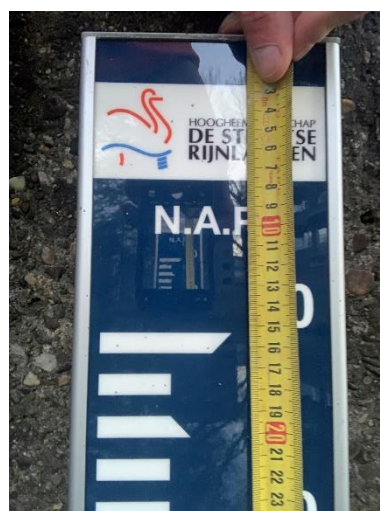
Figuur 9-12: Aflezing rolmaat niet op de witte streep.
