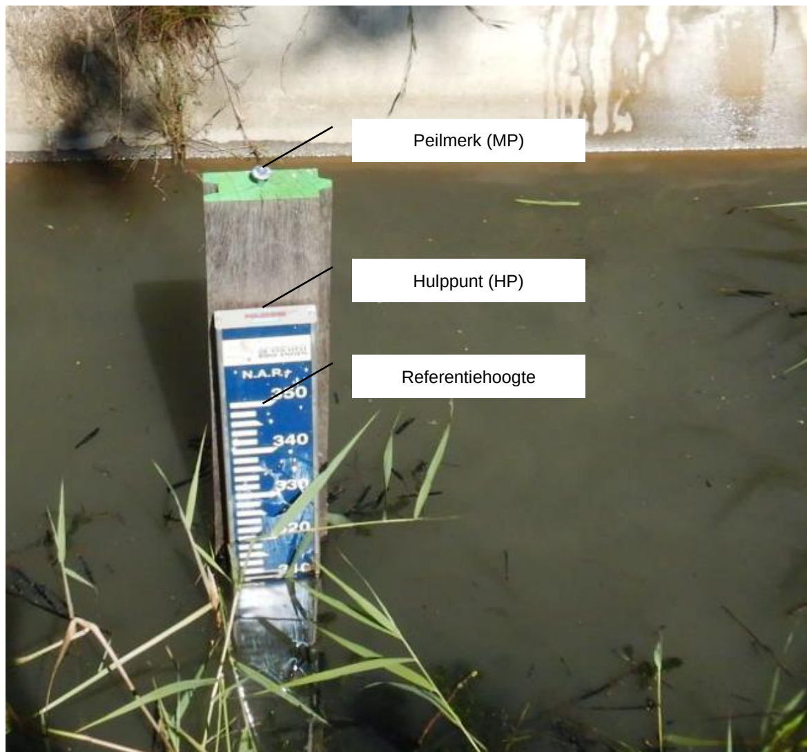
Figuur 9-1: Locatie peilmerk ten opzichte van peilschaal
