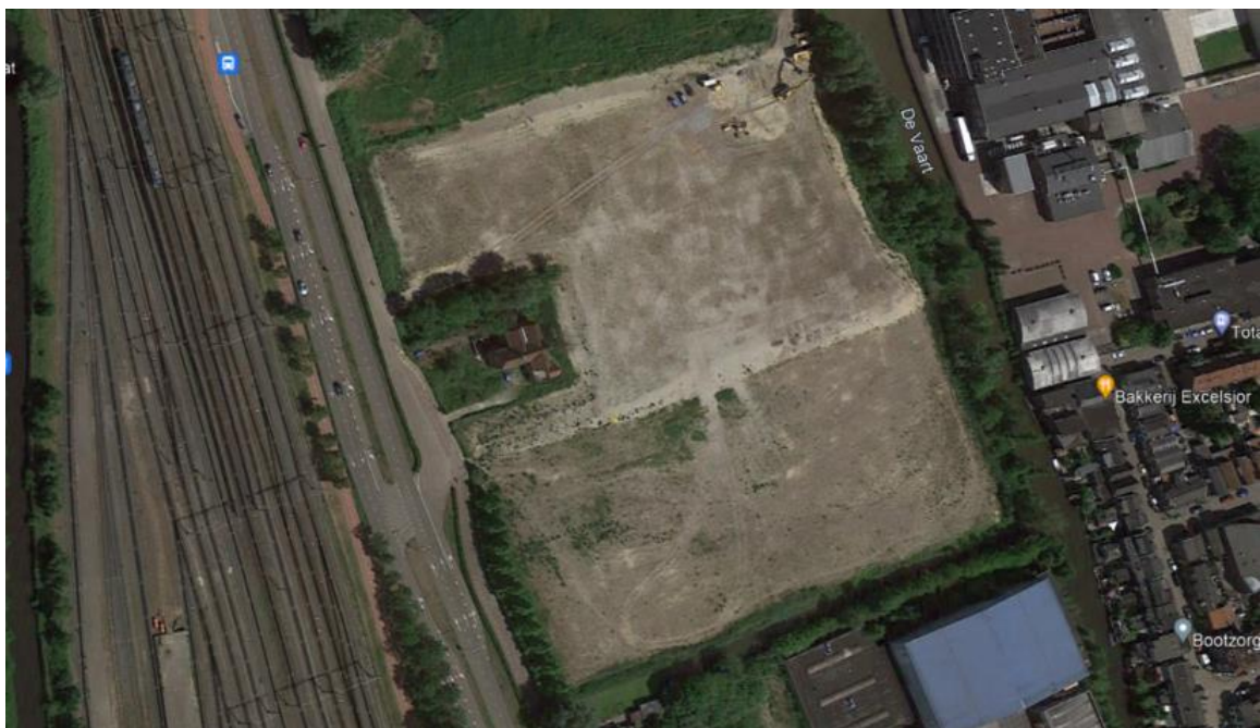
Figuur 4-7: Voorbelasting op middengebied met onbelaste oostelijke randzone (langs De Vaart)
