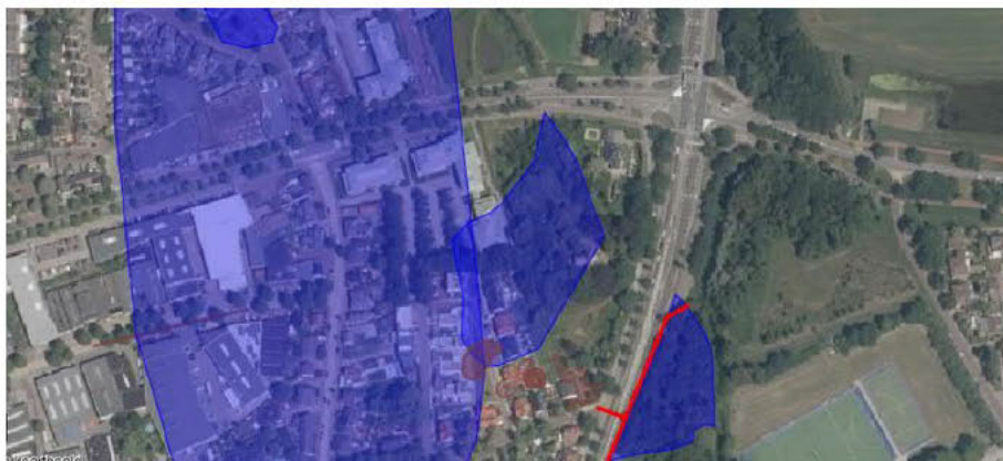
Figuur 1: In blauw bekende grondwaterverontreinigingen nabij de projectlocatie. In rood: een gedeelte van het geplande riooltracé/ bemalingstracé.
