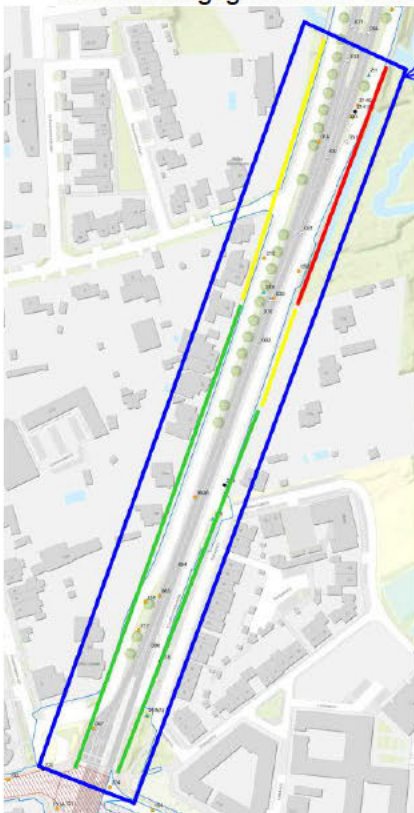
Figuur 3: In rood: bemalingslocatie in of nabij de bekende grondwaterverontreiniging. Geel: kwaliteit/beïnvloeding verontreiniging op voorhand onbekend. Groen: grondwater maximaal licht verontreinigd en buiten het beïnvloedingsgebied van het rode bemalingstraject. Zie bijlage 2 voor gehele tekening.
