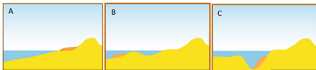
Figuur 2 Strandsuppletie (A), vooroeversuppletie (B) en geulwandsuppletie (C)
