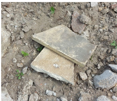
Figuur 12: Aangetroffen asbest op locatie (bron: foto REASeuro).
