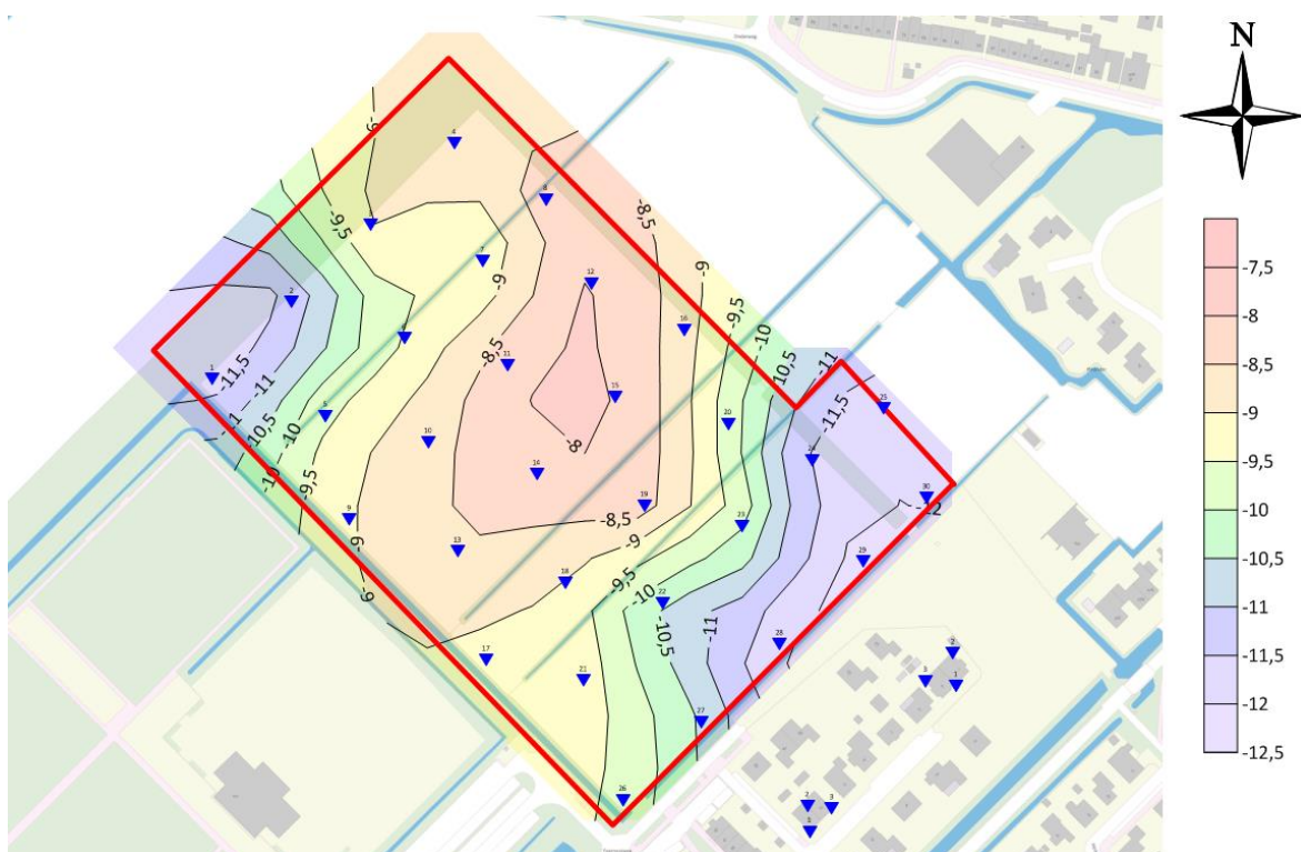
Figuur 3-1 Onderkant samendrukbaar pakket [m NAP] gebaseerd op in het gebied beschikbare sonderingen (blauwe punten), tussen de sonderingen met de methode Kriging geïnterpoleerd.
