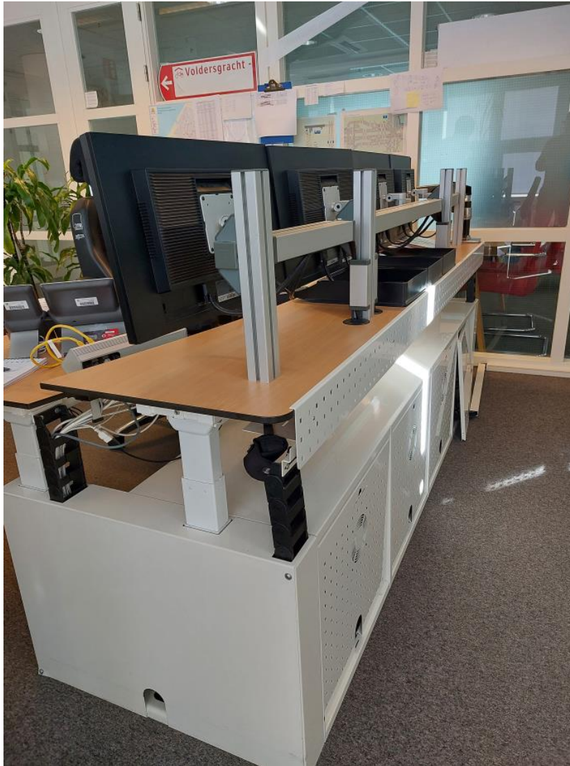
Figuur 2: achterkant van de werkplek met toegangsluiken tot de compartimenten voor plaatsing apparatuur.
