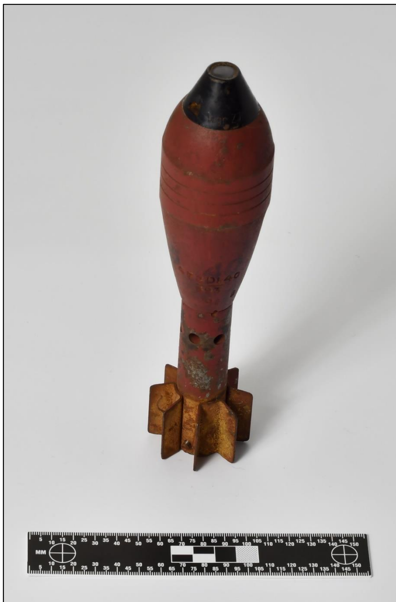
Figuur 21 t/m 23. Links: Een brisantgranaat van 5 cm mortier in nieuwstaat. Onder: Schematische weergave van de schokbuis WgrZ. 38. Boven: een 5 cm Granatwerfer 34 in gebruik. Bron: Collectie BeoBOM/Weaponsandwarfare
