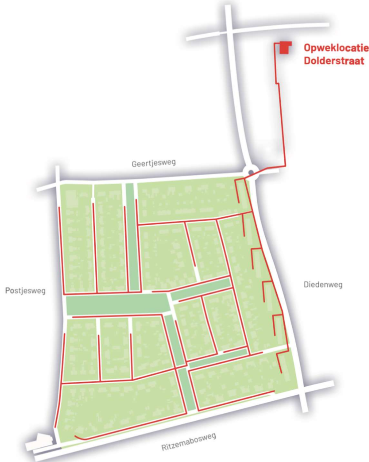
Afbeelding 3: Opweklocatie en leidingnetwerk warmtenet
