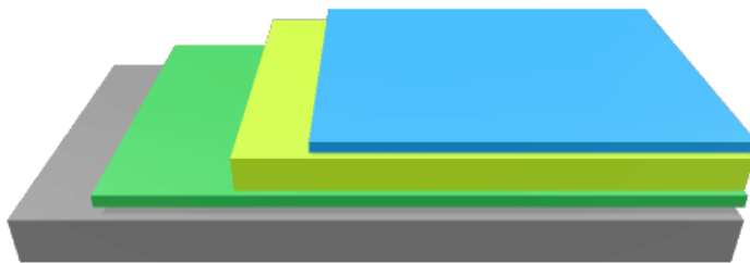
Illustratie: Grijze laag = ondergrond, groene laag = hechtlaag, gele laag = rubberlaag, blauwe laag = toplaag
