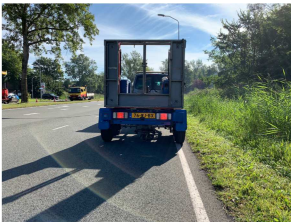
Afbeelding 3: Uitvoering valgewichtdeflectiemeting in situ
