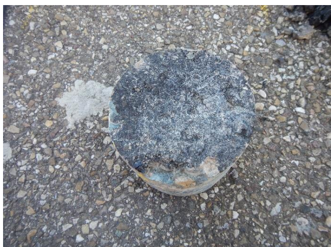
Afbeelding 19: Verouderd membraan op D I
