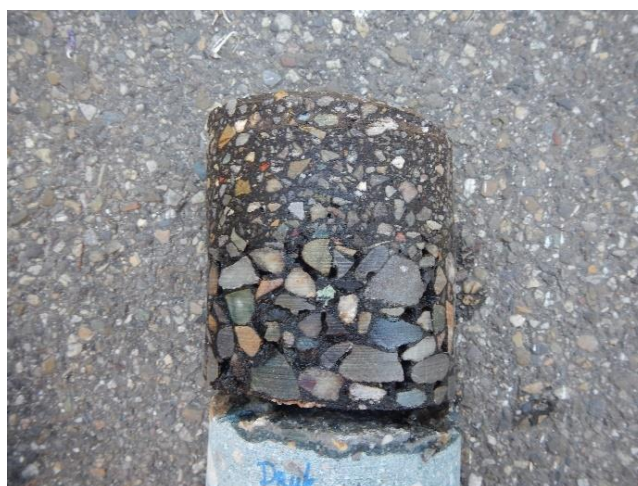
Afbeelding 20: Zeer open structuur op onderste laag asfalt bij D II
