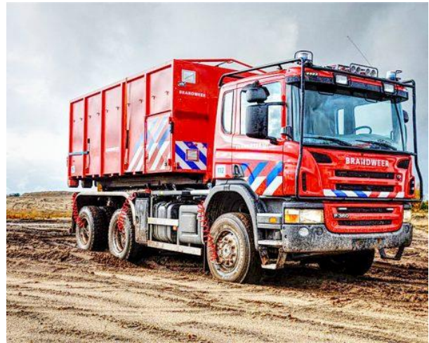
Afb.: Voorbeeld van een aflaatsysteem met ventielenblok en luchtleidingen naar de bandenventielen. Bron: TI Systems
