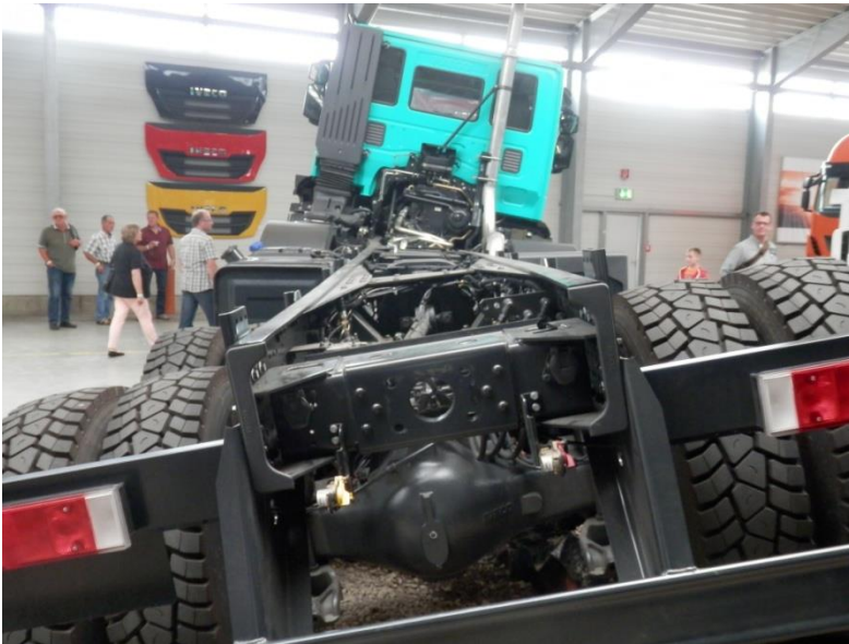
Afb.: Torderen van een chassis. Bron: IFV
