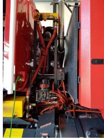
Afb.: Ommanteling van bekabeling en leidingen middels rode siliconenmantels. Afb.: IFV
