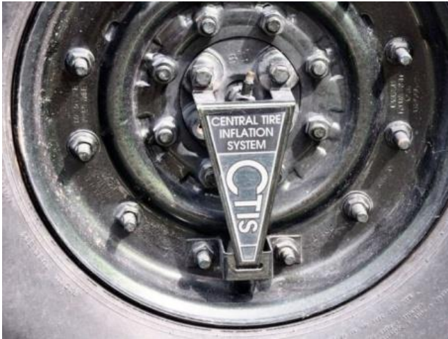
Afb.: Voorbeeld van een centraal aflaatsysteem Bron: TI Systems
