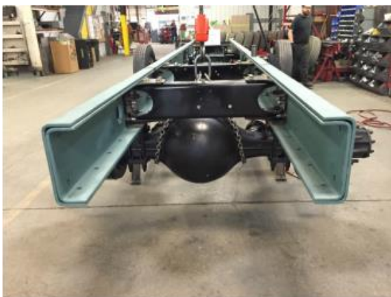
Afb.: Binnenversterking (inliners) in langsliggers Bron: Sutphen Fire Trucks
