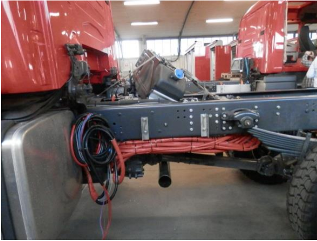
Afb.: Ommanteling van bekabeling en leidingen middels rode siliconenmantels. Afb.: IFV
