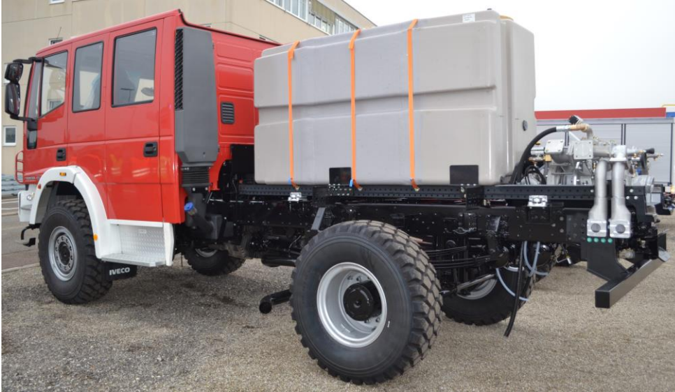
Afb.: apart geconstrueerde bluswatertank. Bron: IFV
