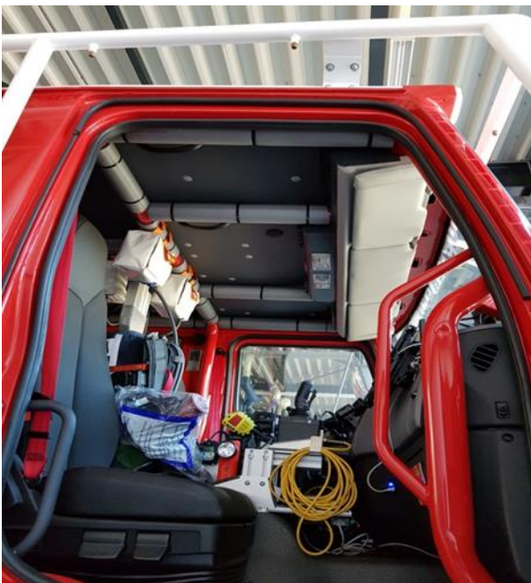
Afb.: ROPS in een TS-BT. Bron: IFV
