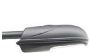
Type: NANO-2 Lamp: LEDs NW Dim: Optioneel Paaltop: Ø48-60 mm LPH: 5, 6, 7½, 8 en 9 m Leverancier: Schröder N.B. Indien van toepassing inclusief opzetstuk en pasring
