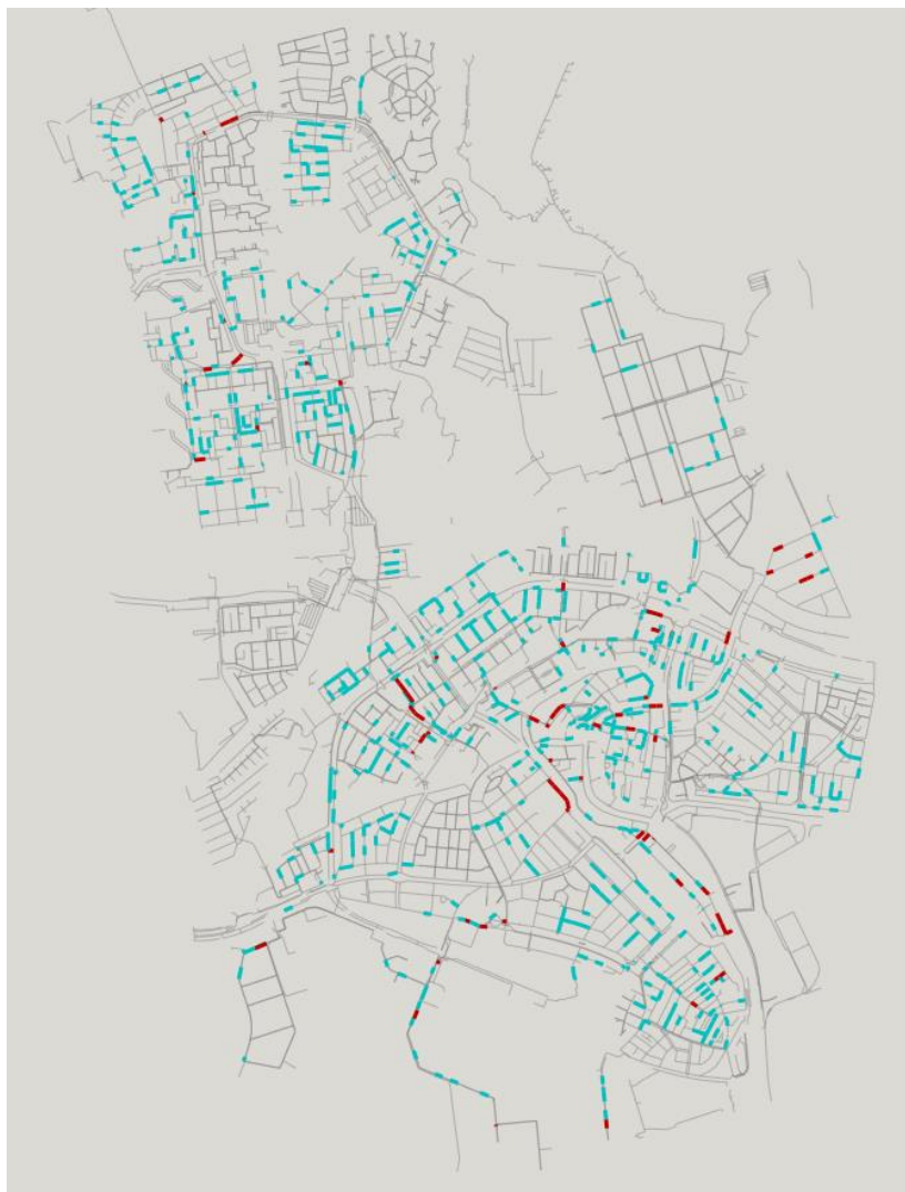
Figuur 17: In rood de weergave van de op basis van kwaliteit te vernieuwen riolen. In blauw de te repareren riolen.
