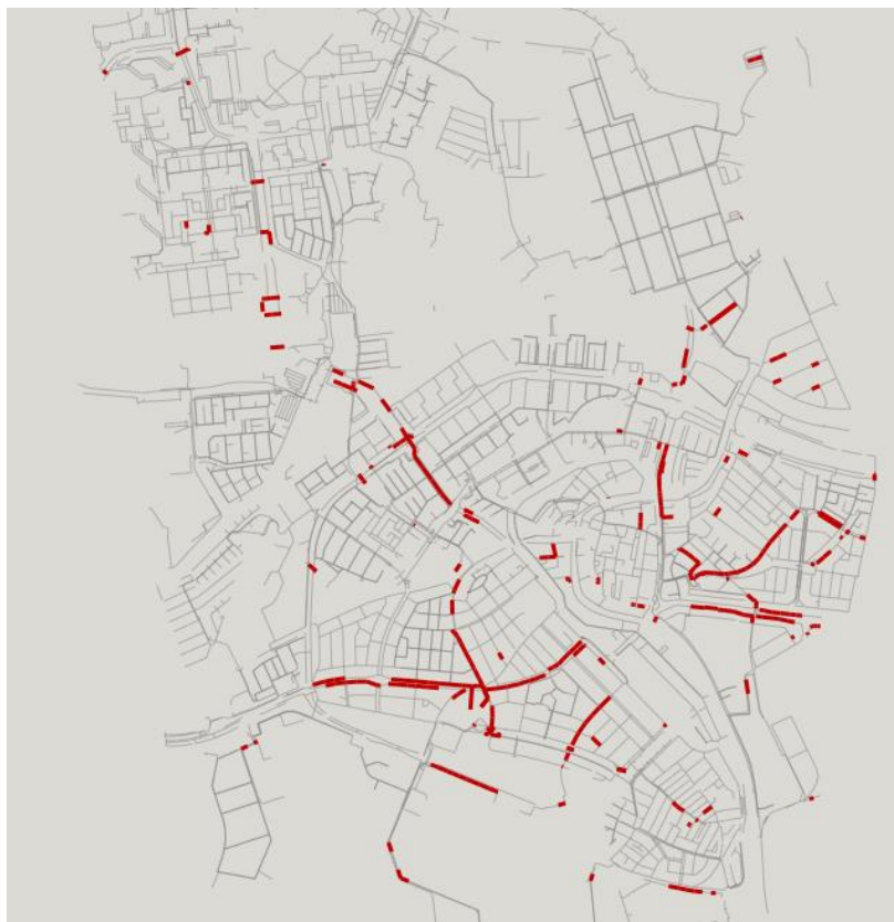
Figuur 18: Een overzicht van riolen die op basis van de degradatiekrommen theoretisch vernieuwd moeten worden. De gepresenteerde selectie zijn riolen waarvan geen inspectie beschikbaar was.
