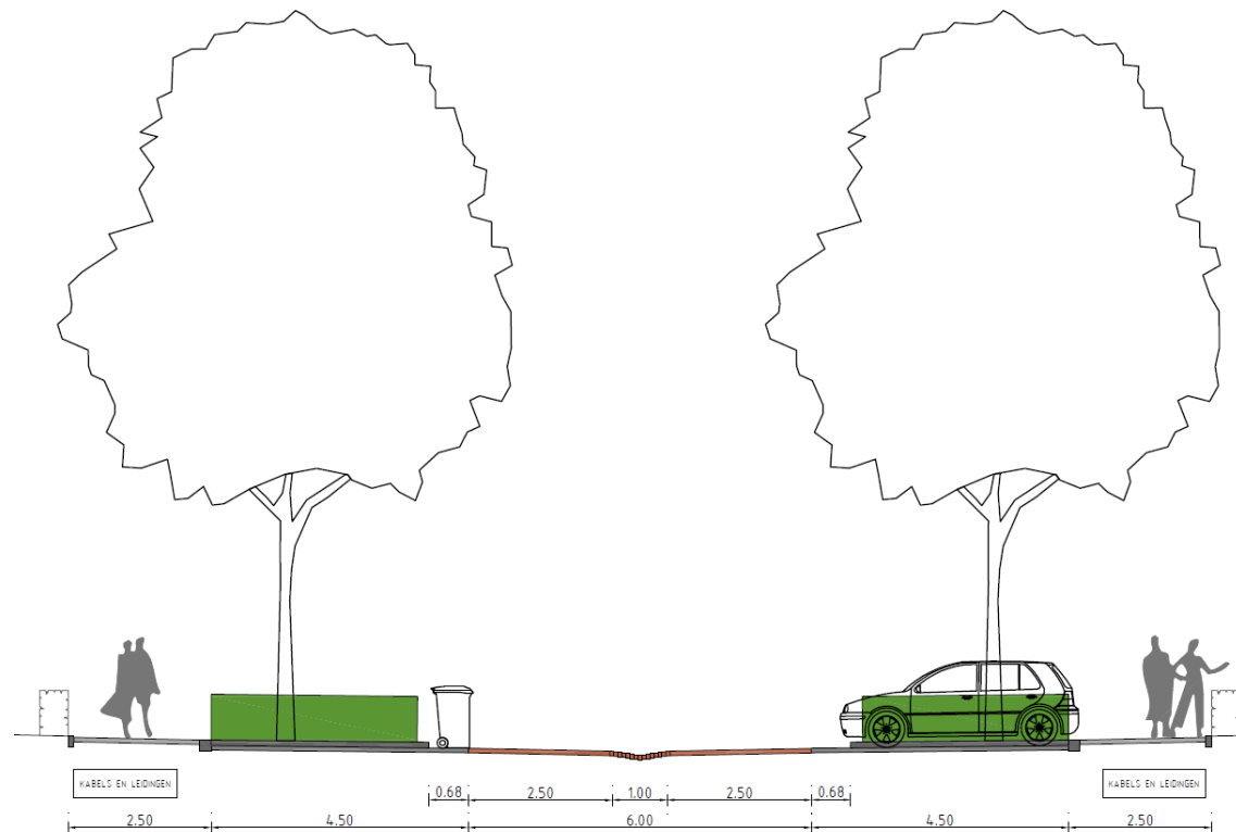
Figuur 2 Dwarsprofiel van een van de straten. Bron: Bijlage J "DO Stedenbouwkundig plan Groenpoort d.d. 04-03-2022".
