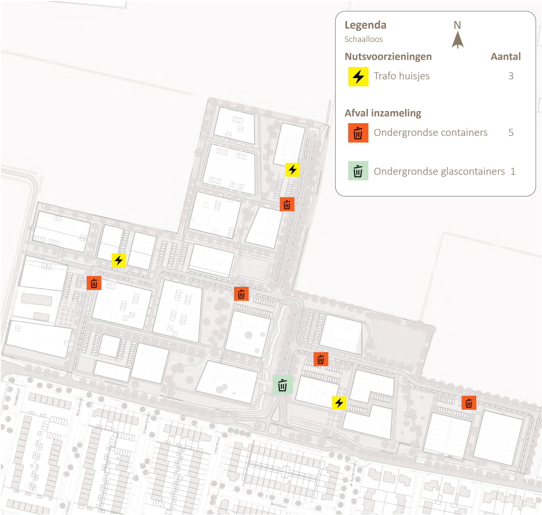
Aanduiding locaties trafo huisjes en ondergrondse containers
