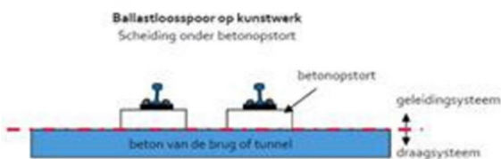
Figuur 2, Demarcatie geleidesysteem (ballastloos spoor) en draagsysteem
