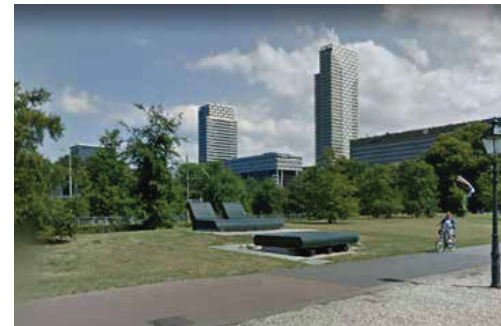
HTM-trafostation onder de Koekamp, de oversized bank en poef verzorgen de toegang en ventilatie
