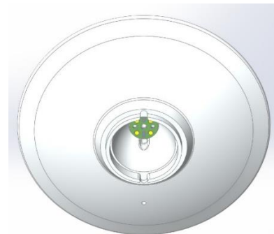
Koelblok schuin van onderen met leds voor de gloeilamp
