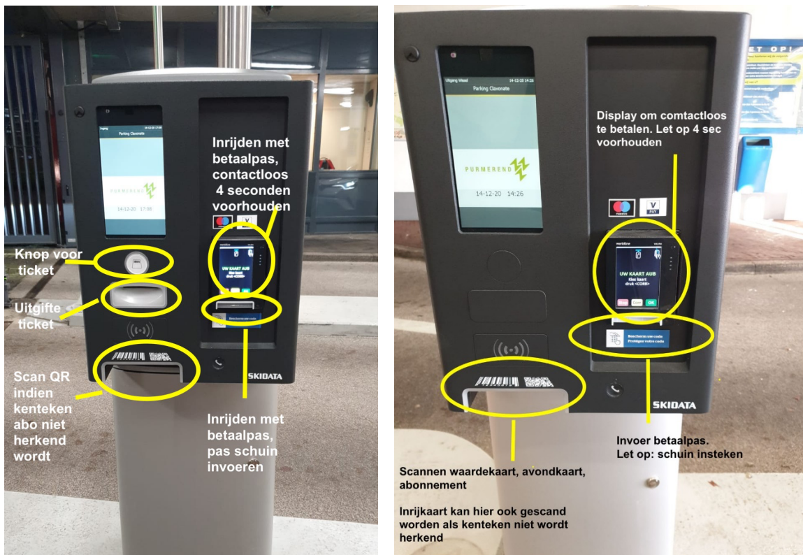
Foto 2. Inrit terminal (links) en uitrit terminal (rechts)
