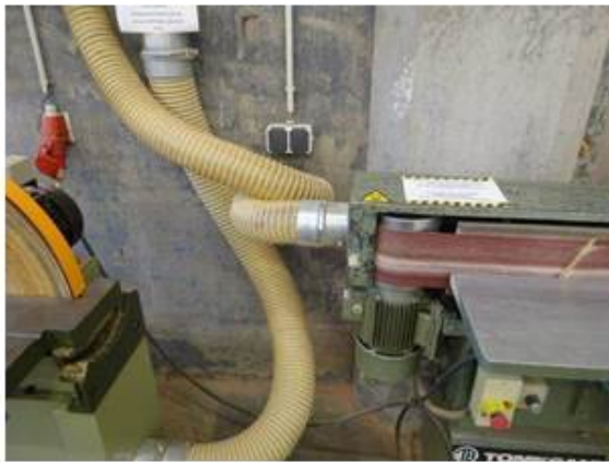
Foto 7 Niet geaarde flexibele afzuiging
