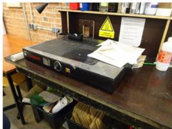
Foto 4 Verwarmingselement met brandbare vloeistoffen
