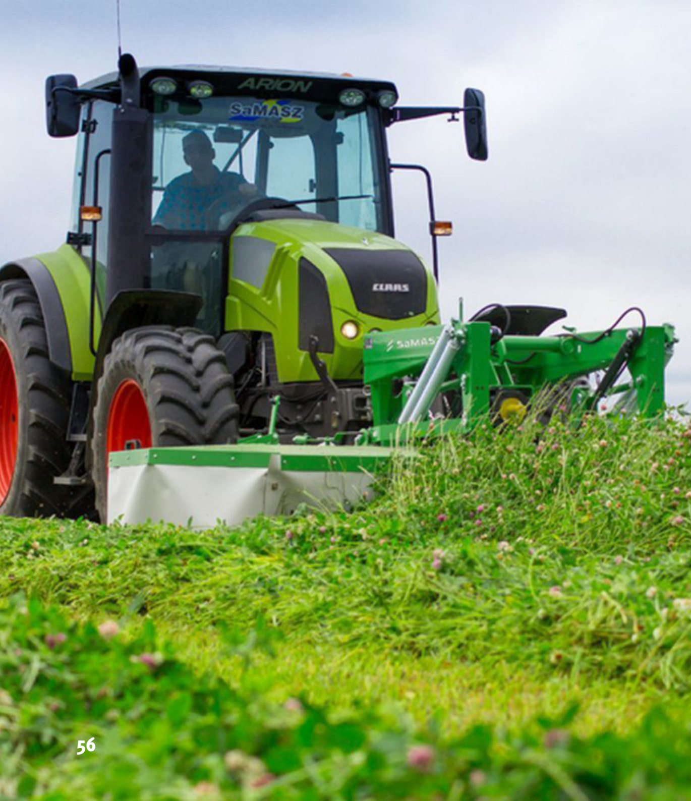
< Figuur A- 10 Het maaien met trommelmaaier (cyclomaaier) (SaMASZ, sd)
