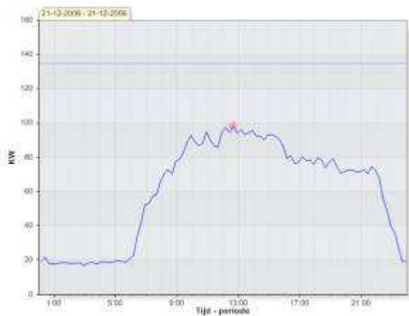
Waarschijnlijk ventilatie met bevochtiging of verwarming andere tijden dan ventilatie
