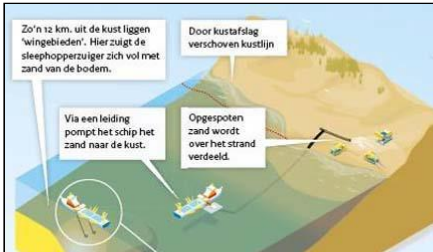
Figuur 2 Schematische weergave uitvoering strandsuppletie
