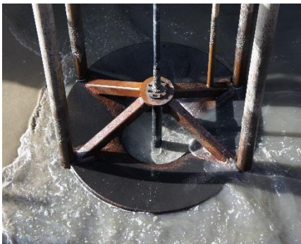
Figuur 4 Overslagpijp ter beperking van slibconcentraties in bovenste deel waterkolom
