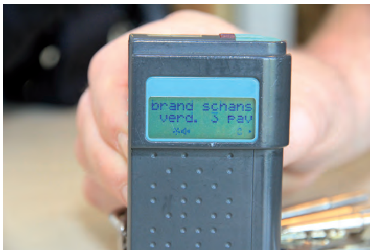
Afbeelding 3.4 alarmering via de personen- zoekinstallatie
