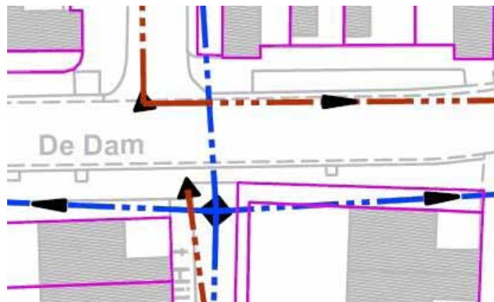
Overzicht riool en drainage i.r.t. kavelgrenzen
