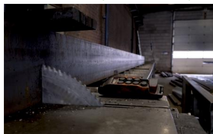
Inkorten onbehandelde stalen balk.
