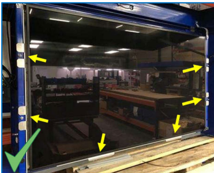
Figuur 5-3: Correcte manier openen TFT-paneel
