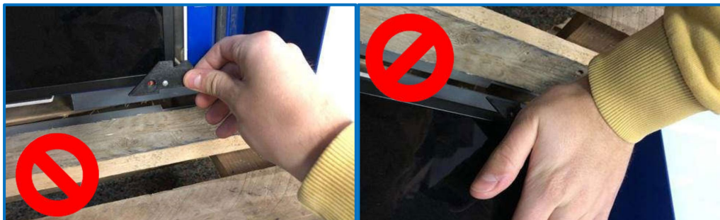
Figuur 5-4: Foutieve manier openen TFT-paneel
