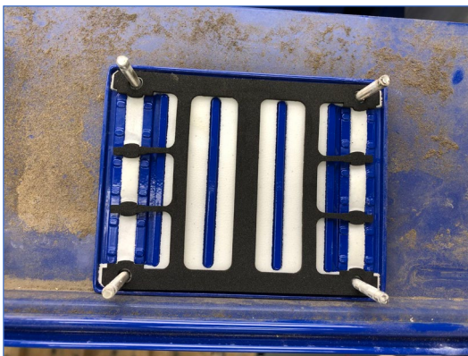
Figuur 6-27: Plaatsen Entrybox-pakking
