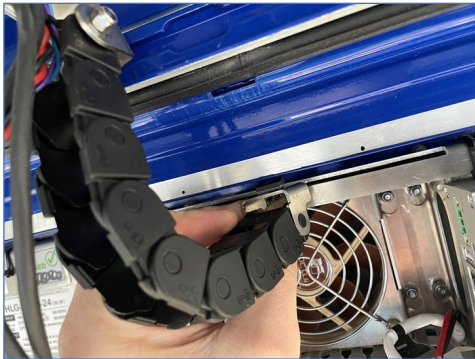
Figuur 6-17: Kabelrups vastzetten
