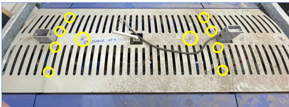
Figuur 5-1: Bouten op grijze afdekplaat
