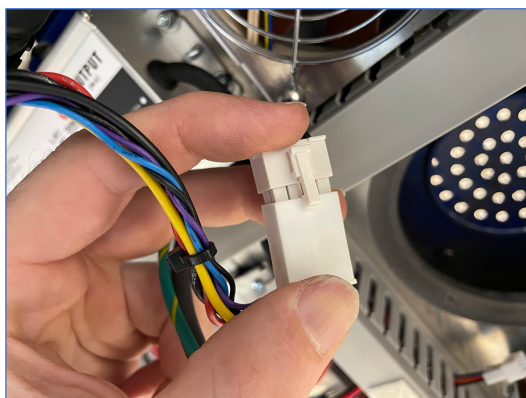
Figuur 6-18: Navelstrengen aansluiten
