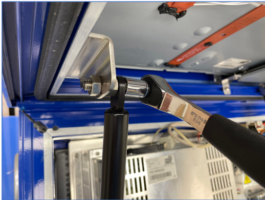
Figuur 5-13: Gasveren loshalen
