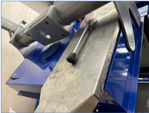
Figuur 7-2: Dirt Collector plaatsen
