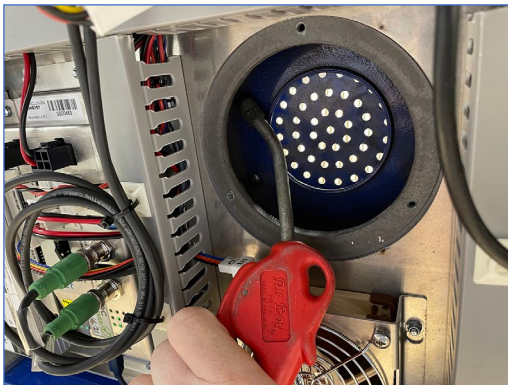
Figuur 7-3: Kanalen schoonblazen
