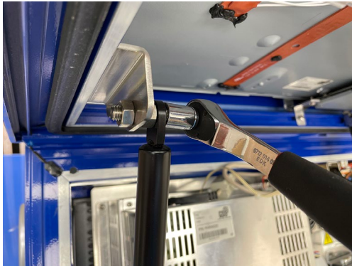
Figuur 5-5: Gasveren loshalen
