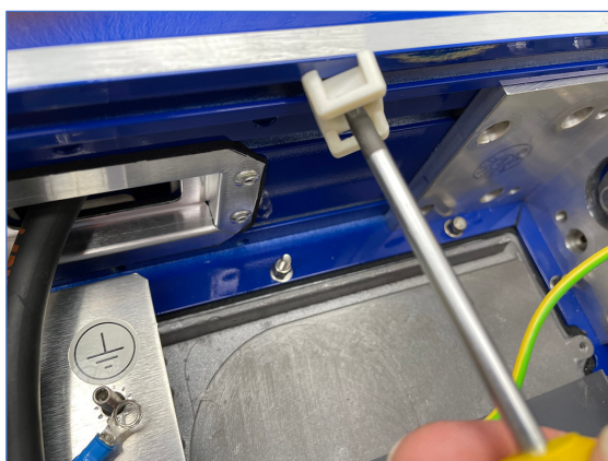
Figuur 5-17: Resterende beugels weghalen
