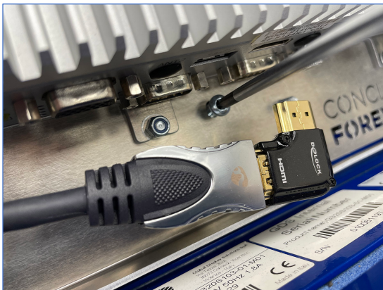
Figuur 6-6: Laatste plaatschroef vastschroeven
