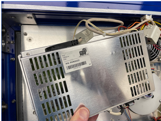
Figuur 5-12: Controller loshalen van backplate
