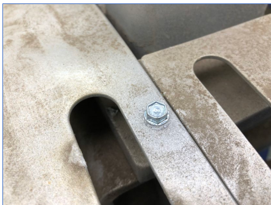
Figuur 7-5: Boorschroef in vrij gat schroeven
