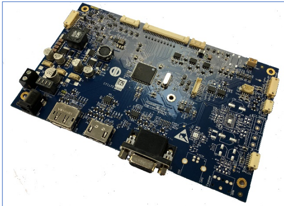
Figuur 3-7: TFT-video-interfaceboard (bovenaanzicht)
