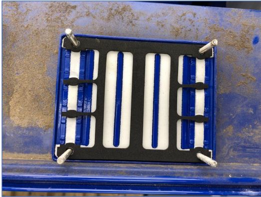
Figuur 6-35: Plaatsen Entrybox-pakking
