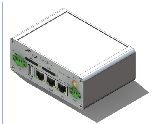
Figuur 3-23: GSM-R-modem (bovenaanzicht)
