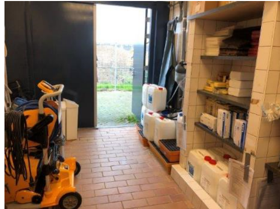
BG Opslag van chemicaliën binnen opgemetselde rand en op opvangbakken
